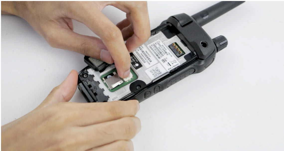
Abbildung 13: Einsetzen der Nano-SIM-Karte
