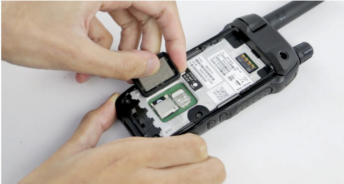
Abbildung 9: Öffnen der Nano-SIM- und microSD-Kartenabdeckung
