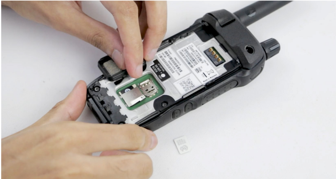
Abbildung 12: Öffnen der Nano-SIM- und microSD-Kartenabdeckung
