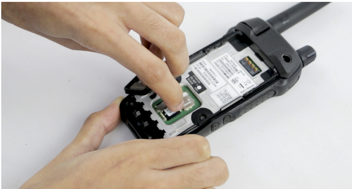
Abbildung 10: Öffnen der microSD-Kartenhalterung
