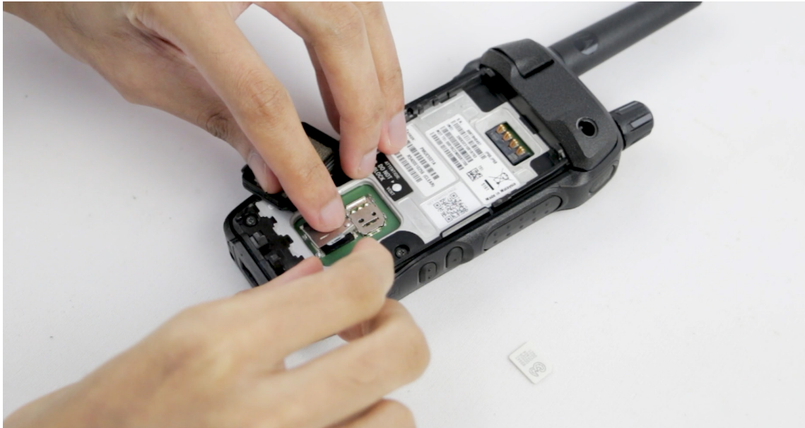
Abbildung 8: Einsetzen der Micro-SD-Karte
