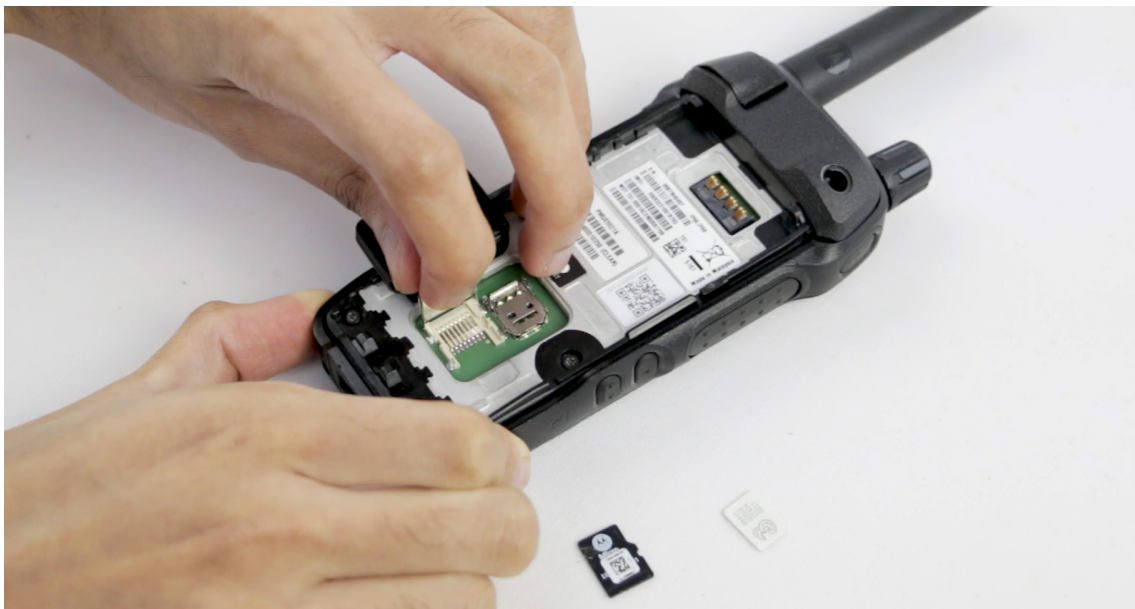
Abbildung 7: Öffnen der microSD-Kartenhalterung
