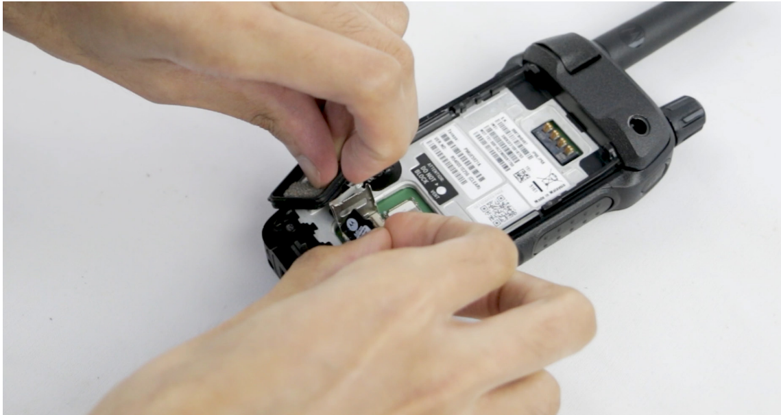
Abbildung 11: Entfernen der microSD-Karte
