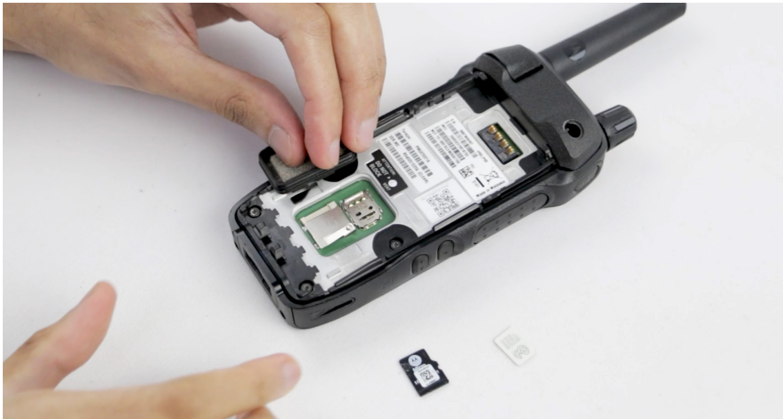
Abbildung 6: Öffnen der Nano-SIM- und microSD-Kartenabdeckung
