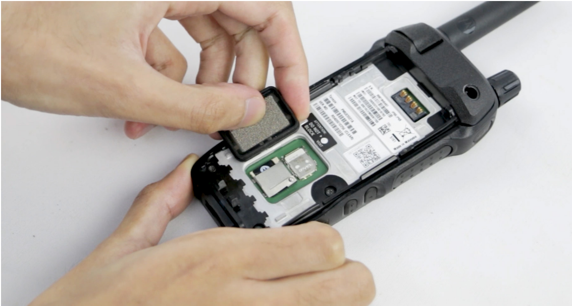
Abbildung 14: Öffnen der Nano-SIM- und microSD-Kartenabdeckung
