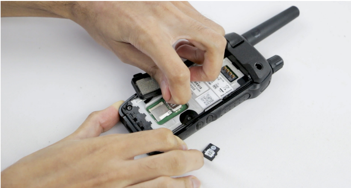
Abbildung 15: Öffnen des Nano-SIM-Kartenhalters
